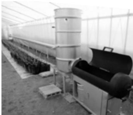
農業ハウス用「ロケットボイラー」20mの煙突がハウス内に伸びる
