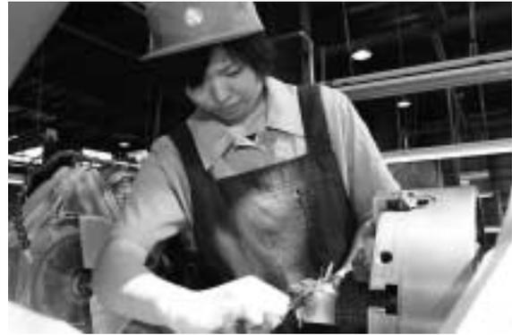
加工した製品の寸法を確認する
